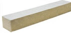
Homogene, nichtbrennbare Putzträgerplatte aus Steinwolle im speziellen Format zur Herstellung von Brandriegeln in Wärmedämm-Verbundsystemen. Mit beidseitiger Vorbeschichtung und hervorragenden Wärmedämmeigenschaften. Wasserabweisend, dampfdurchlässig, alkalibeständig, formstabil und alterungsbeständig. Faserorientierung parallel zur Wandoberfläche.
